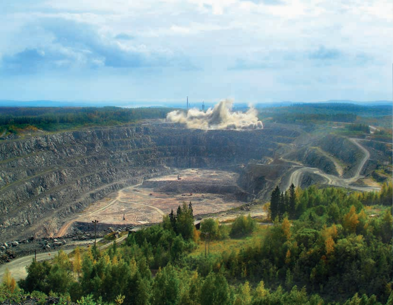
MALMEN FRIGØRES VED EKSPLOSION , som sker ved hjælp af emulsionssprængstof.
